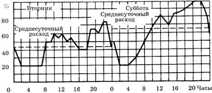
Рис. 7.3. Суточный график горячего водоснабжения жилого района
